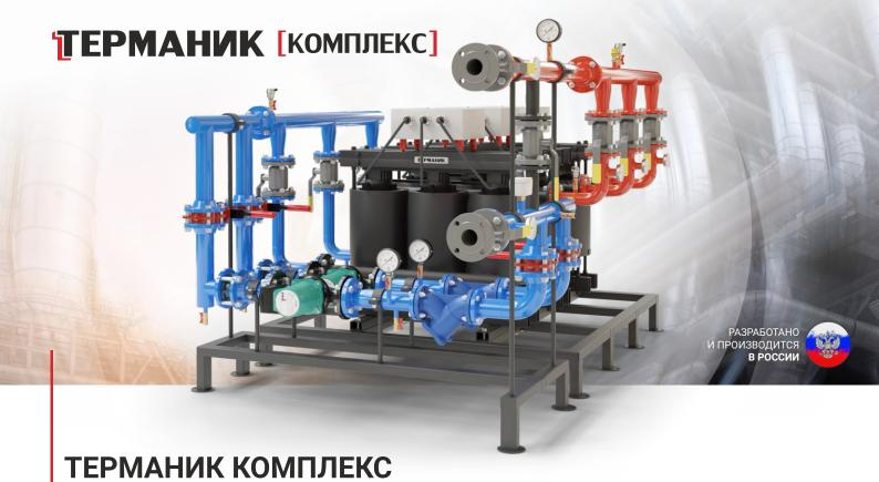
«ТЕРМАНИК КОМПЛЕКС» представляет собой узел нагрева в сборе, куда входит один или несколько индуктивно-кондуктивных электронагревателей «ТЕРМАНИК» с полной электрической и гидравлической обвязкой (циркуляционные насосы, запорно-регулирующая арматура, КИПиА, система управления).
