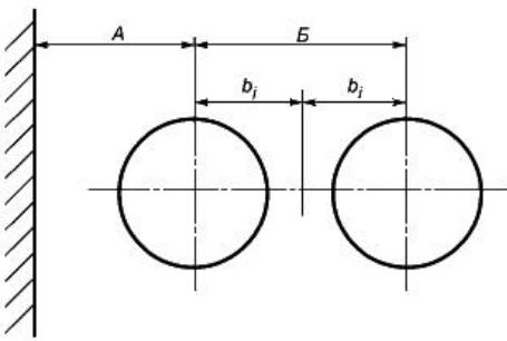
Рисунок 10.1 - Расположение трубопроводов
