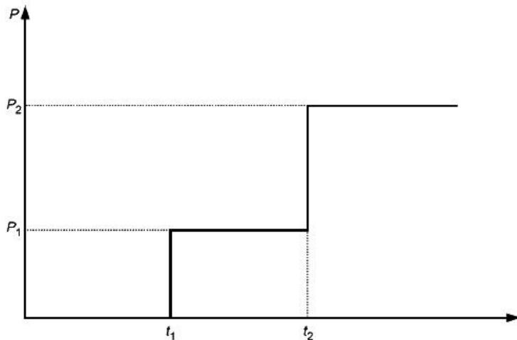
$P_1$  - давление пуска;  $P_2$  - давление рабочее;  $t_1$  - минимальная температура воздуха, при которой допускается пуск трубопровода под давлением  $P_1$ ;  $t_2$  - минимальная температура, при которой сталь и ее сварные соединения допускаются для работы под давлением в соответствии с требованиями приложения А, таблица А.1
