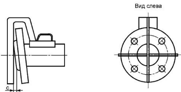
Рисунок 6.1 - Измерительный шаблон для проверки отклонений
